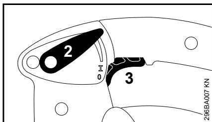
Mit dem Stellhebel (2) kann der Gashebel (3) während der Arbeit in beliebiger Stellung arretiert werden.
