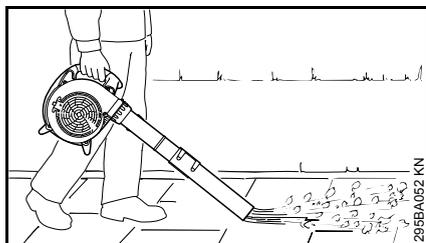
Das Blasgerät ist für Einhand-Bedienung ausgelegt. Es muss von der Bedienungsperson mit der rechten Hand am Bedienungsgriff getragen werden.
